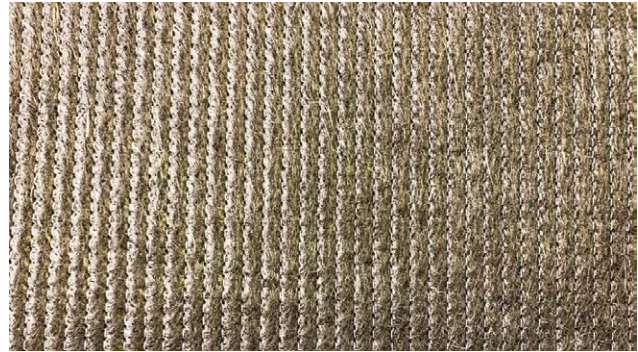
Abb. 3: NCF aus gefertigten Carbonfasertapes (Quelle: CHOMARAT).
