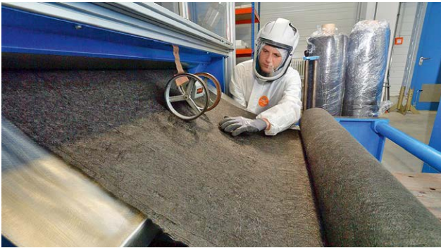
Abb. 2: Herstellung eines vernadelten Carbonfaservliesstoffes (Quelle: STFI).
